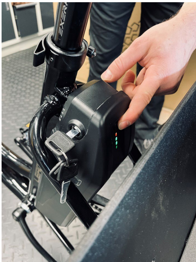
Obrázek 12 - Zapnutí baterie elektrokola
