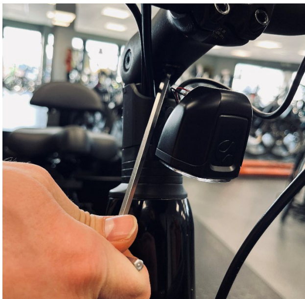
Obrázek 5 - Uvolnění šroubu stavitelného představce
